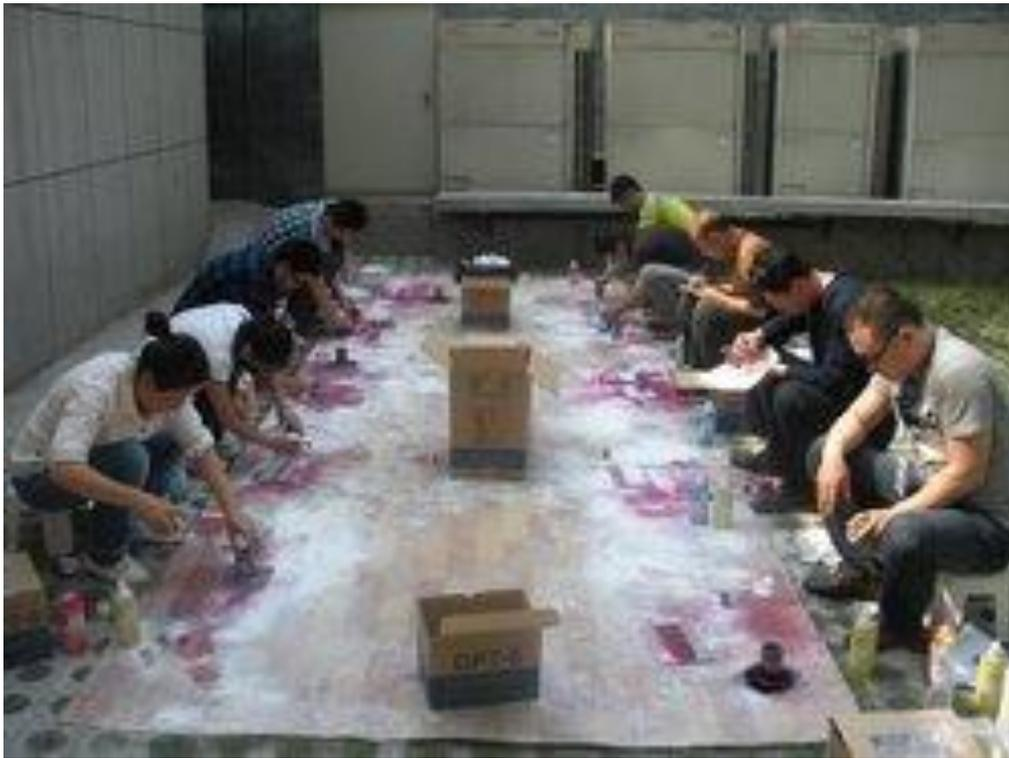
本实训室适用于检测专业、飞机专业、发动机专业、焊接等专业进行渗透检测的操作培训，培养学生正确操作仪器设备，按规程与标准熟练进行探伤操作的能力，并能出具合格检测报告。
