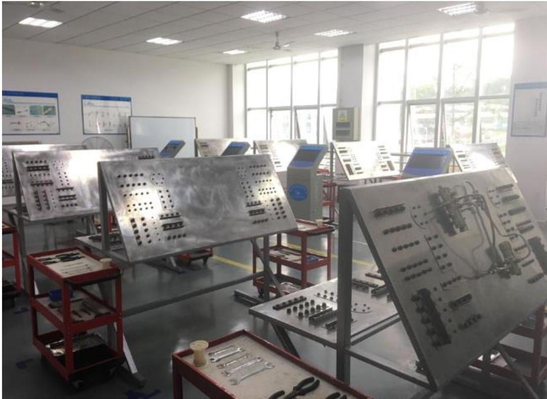
该实训室是模拟飞机上各类紧固件保险练习实训室，占地面积128 平米，紧固件练习架 10 个，工具车 20 辆，打磨机一台，设备总价值 20 多万。建设总经费 30 多万。
