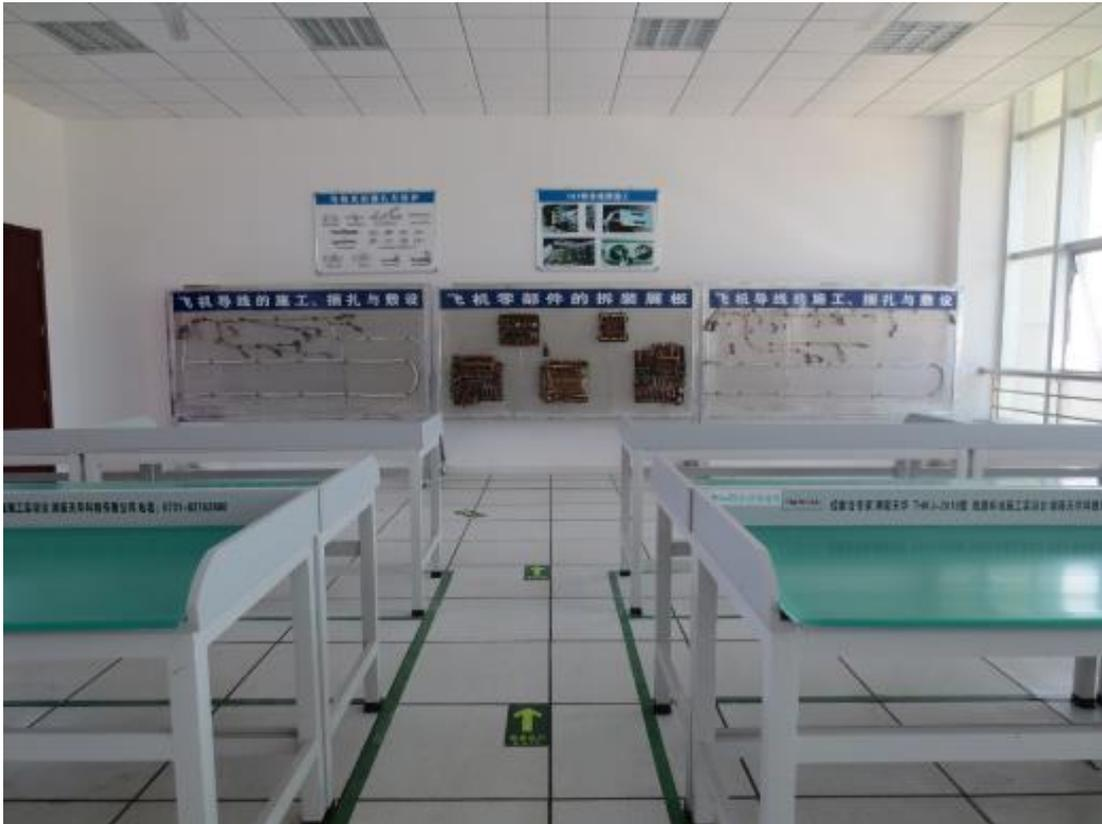
线路标准施工实训室针对航空公司、航空军工厂及其它航空维修企业的用人需求，主要承担导线的捆扎与束缚、导线绝缘层修理、导线线芯的修理、接线片的修理、拼接头和热缩管的使用、航空插头的修理、邦迪块的修理、军用插头的修理、接地桩的修理、线路导通及绝缘性的测量等十几个项目，让学生掌握线路标准施工的基本方法和基本技能。
