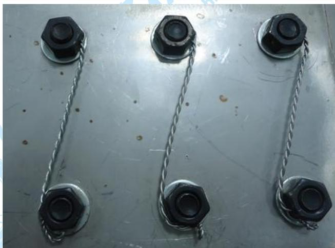
图 1 标准六角螺栓螺帽紧固件铁丝保险示意图
