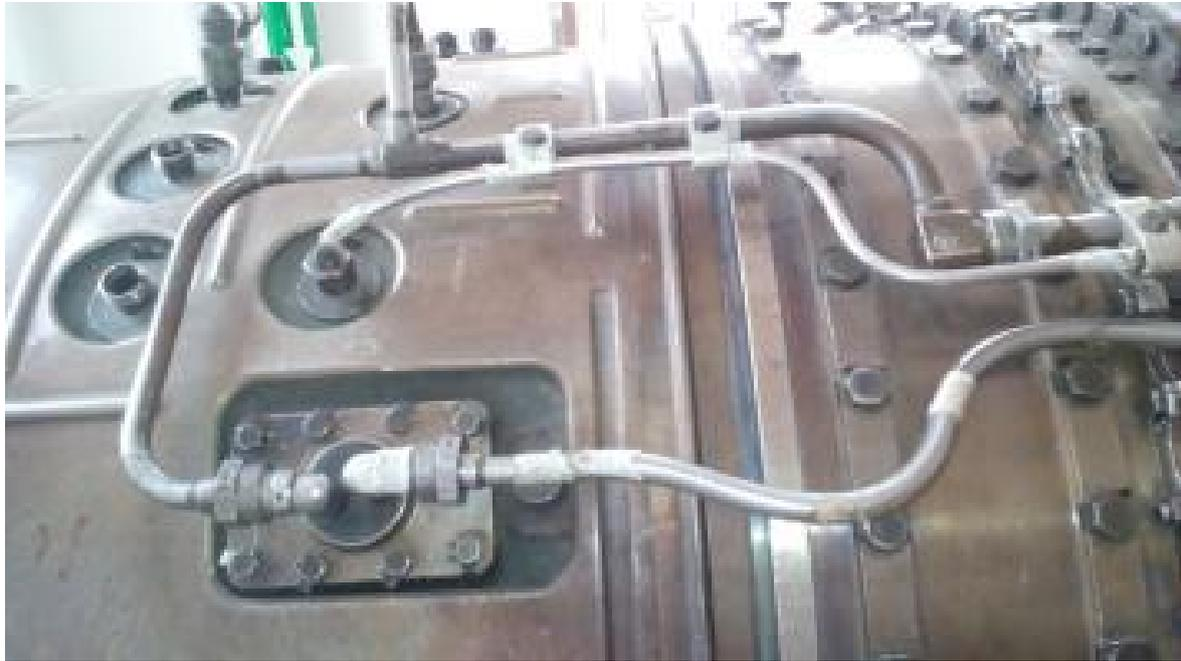
图1 发动机导管拆装示意图
